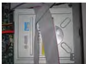
Fig 2.3 Connessione del masterizzatore DVD
