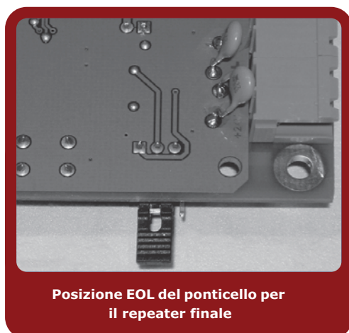
Figura 23 - Scheda EASYPAN/LCD - posizione del ponticello
