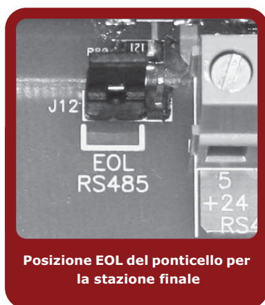
Figura 24 - Scheda EASYLEVEL40/N - posizione del ponticello
