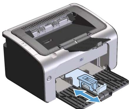
4. Al termine della stampa con il vassoio per piccoli formati, rimuovere il vassoio e riportarlo nel vano accessori.
