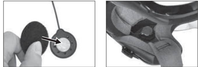
5. Fissare il microfono con asticella in dotazione nel "Kit di base" tra l'imbottitura interna e l'involucro esterno. Il microfono con asticella dovrebbe essere fissato sulla superficie interna dell'involucro esterno in modo che sia perfettamente rivolto verso la vostra bocca. Assicuratevi che il microfono sia posizionato vicino alla vostra bocca quando indossate il casco. È possibile utilizzare
