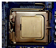
Fig. 3 Fate attenzione al piccolo triangolo dorato posizionato sull'angolo della presa della CPU.
