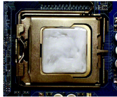
Fig. 1 Applicare uno strato uniforme di pasta dissipatrice di calore sulla superficie della CPU installata.
