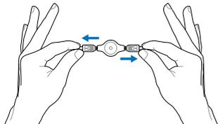
Tirare i connettori USB alle due estremità (non completamente) per allungare il cavo mini-USB.
