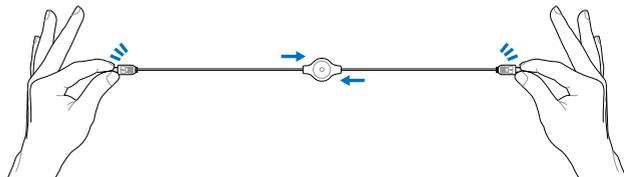
Tirare i connettori USB completamente alle due estremità e ritrarre lentamente il cavo mini-USB.
