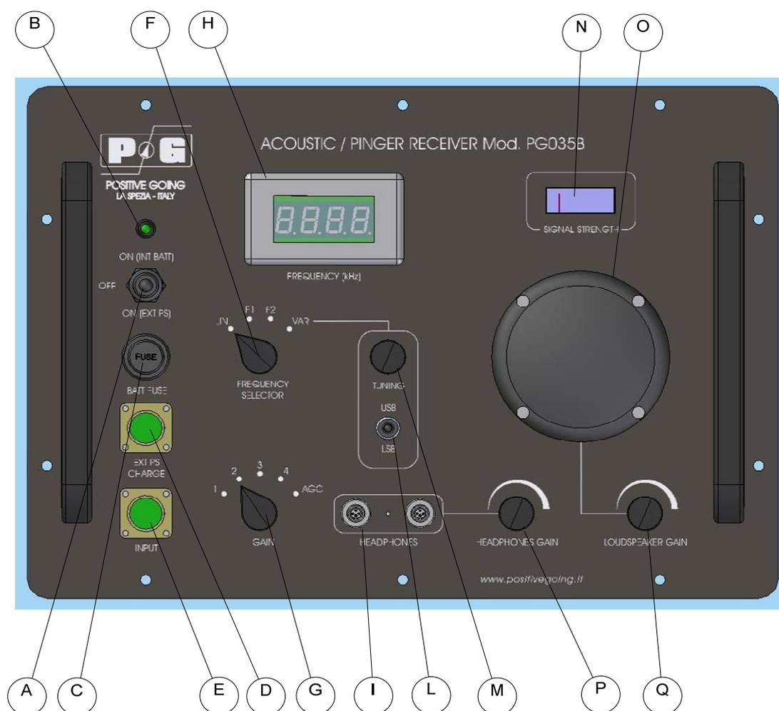
Figura 2 - Pannello comandi del Ricevitore Acustico Mod. 035B
