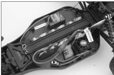
Installazione tipica vettura elettrica
