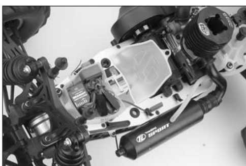
Installazione tipica vettura a scoppio
