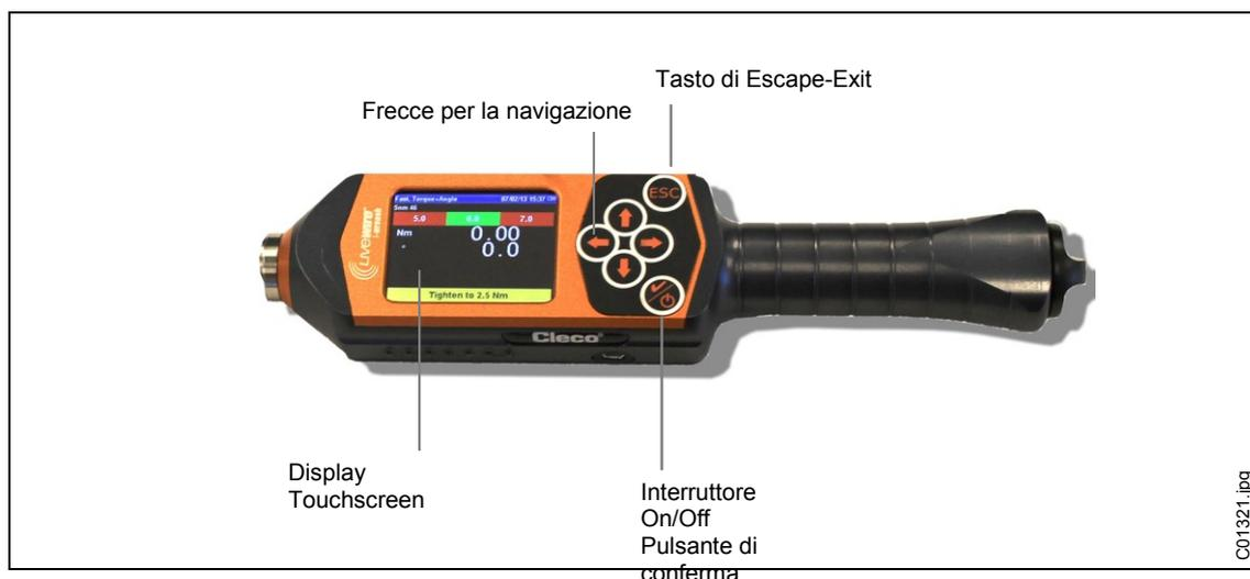
Fig. 4: Setup del Wi-Fi nell'utensile LiveWire I-Wrench
