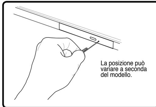
L'espulsione di emergenza è localizzata in un foro sul lettore ottico e viene utilizzata per estrarre il cassetto del lettore ottico nel caso in cui l'espulsione elettrica non dovesse funzionare. Non utilizzare l'espulsione di emergenza al posto dell'espulsione elettronica. **NOTA: Assicurarsi di non danneggiare l'indicatore di attività situato nella stessa zona.**
