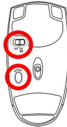
2. Impostare su ON (Attivo) l'interruttore d'alimentazione sulla parte inferiore del mouse.
