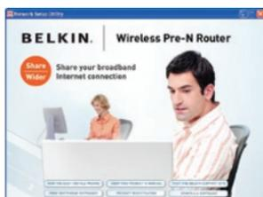
**Per gli utenti Windows:** inserire il CD-ROM con il programma di installazione guidata nell'apposito drive. La schermata Network Setup Utility (Utility di configurazione rete) comparirà automaticamente sullo schermo entro 15 secondi. Per cominciare, fare clic su "Run the Easy Install Wizard" (il programma di installazione guidata).
