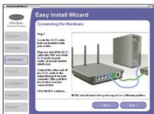
**2.2** Questo passo spiega come individuare il cavo BLU in dotazione con il Router. Inserire un'estremità del cavo in una QUALSIASI porta BLU del Router. Inserire l'altra estremità del cavo nella porta di rete del computer. Fare clic su "Next" (Avanti) per continuare.
