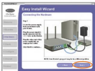
**2.3** Questo passo spiega come individuare l'alimentatore in dotazione con il Router. Inserire il connettore piccolo dell'alimentatore nella porta GRIGIA del router. Quindi, inserire l'alimentatore in una presa di corrente. Fare clic su "Next" (Avanti) per continuare.
