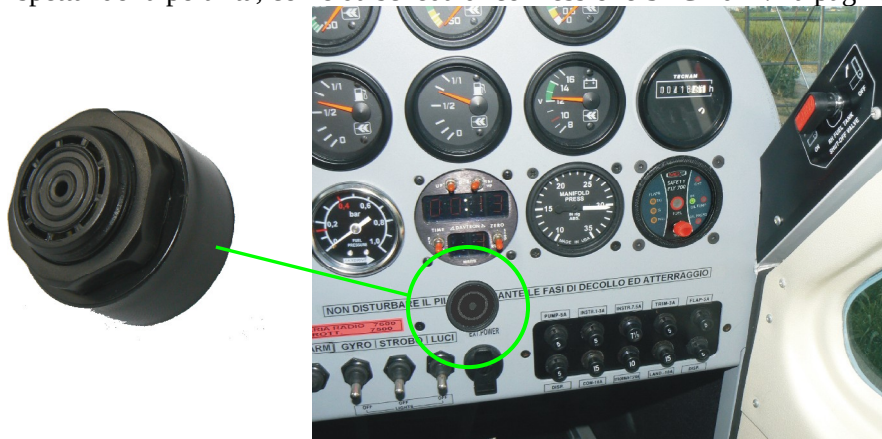
Fig. 4 Buzzer montato in plancia strumenti motore .
