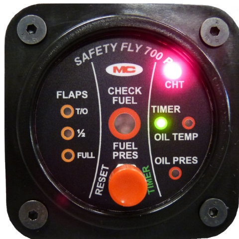
Fig.7 esempio allarme temperatura testata
