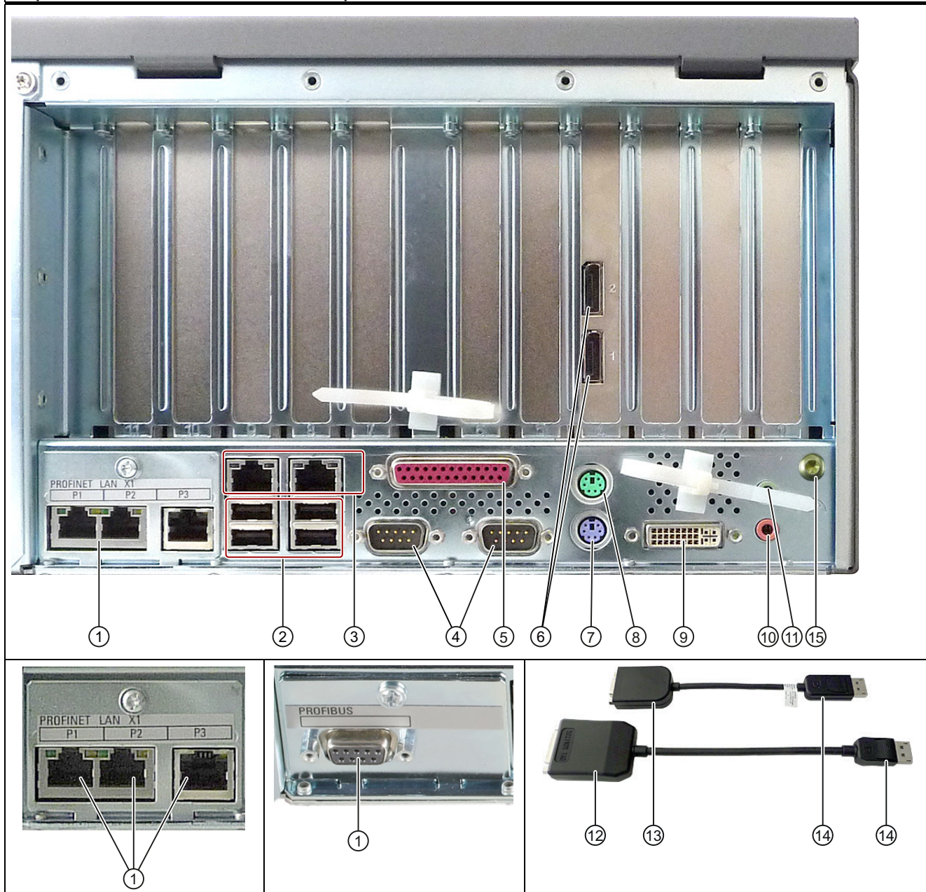
Disposizione delle interfacce sul retro del dispositivo
