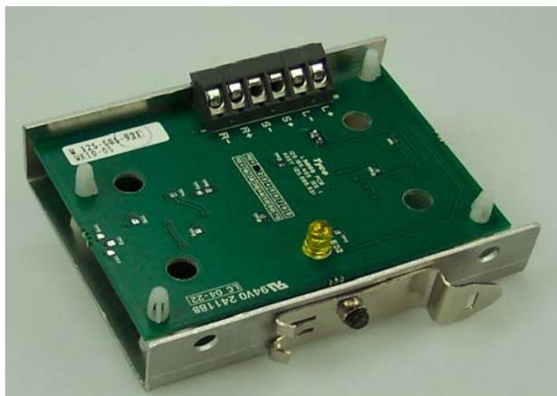
Fig. 20: FC410LIM montato su staffa di montaggio per guida DIN
