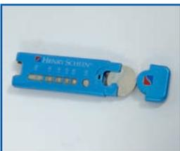
Setzen Sie eine neue Batterie (Typ CR2450) Art. Nr. 900 3648 ein. Vergewissern Sie sich, dass die Batterie mit der + Markierung nach oben in das Batteriefach eingesetzt wurde. Schieben Sie das Batterieschubfach zurück in das Gehäuse.
