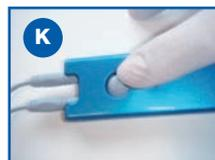
**REMARQUE:** Pour désactiver l'alarme, appuyer sur le bouton gris sur l'arrière de l'appareil. (Image K). Pour le réactiver, appuyer sur ce même bouton
