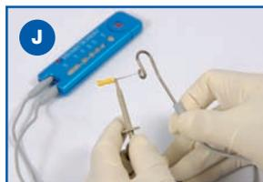
2. Die grüne LED blinkt nach dem Selbsttest, so wird angezeigt, dass sich der **Digital Apex Locator** im Stand-by Modus befindet.
