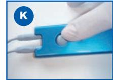
**NOTA:** Para parar el sonido de alarma, presione el botón gris en la parte trasera (Fig. K). Para reactivarlo, pulse de nuevo el botón.
