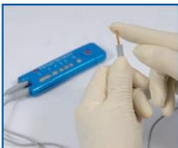
◀ Schließen Sie den Minifeilenclip und den Lippenhaken an die Anschlüsse am Ende des Einsteckkabels an (entweder rechts oder links).
