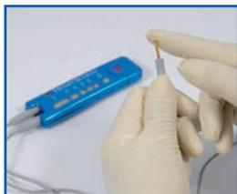
◀ Inserte el sostén de la mini lima y engánchelo en las conexiones que se encuentran en el extremo de los cables (a la izquierda o derecha).
