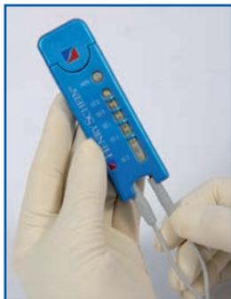
◀ Inserte las conexiones de los dos cables principales en los pivotes de la punta del HS-Apex Locator.
