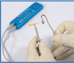
Schalten Sie den Apex Locator durch Betätigen des "ON" Schalters an der Vorderseite des Gerätes oder durch Berührung des Mini-Feilenhalters mit dem Lippenhaken ein. Direkt nach dem Einschalten werden die LEDs durchlaufend aufleuchten, der "Selbsttest".
