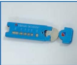
Reemplace con baterías nuevas (tipo CR2450). Asegúrese de insertar la batería en la gaveta con el signo (+) hacia arriba.
