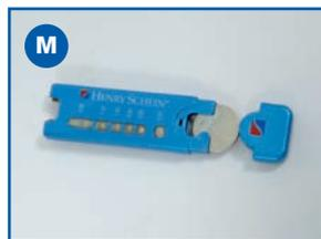
**REMARQUE:** Si le **Digital Apex Locator** n'est pas utilisé pendant une longue période, il est recommandé de le ranger sans la pile, afin de prolonger sa durée vie.
