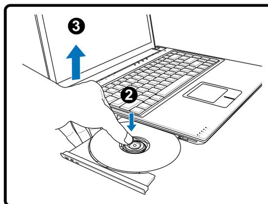
2. Premere verso il basso nel centro facendo leva sul bordo del disco nell'angolo in alto per rimuoverlo.
