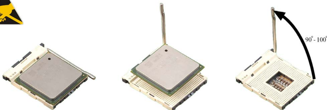
Figura 5. Inserimento/disinserimento della CPU
