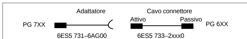
Figura 3-13 Direzione di innesto: adattatore-cavo connettore
