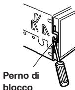
Far entrare il DVE-5207 il più possibile nel cruscotto. Quando l'apparecchio è inserito, verificare che i perni di blocco siano ben assestati nella posizione abbassata. Questo può essere ottenuto premendo fermamente sull'apparecchio mentre si spinge in giù il perno con un piccolo cacciavite. Questo assicura che l'apparecchio sia correttamente bloccato e non fuoriesca accidentalmente dal cruscotto. Installare il pannello anteriore staccabile.
