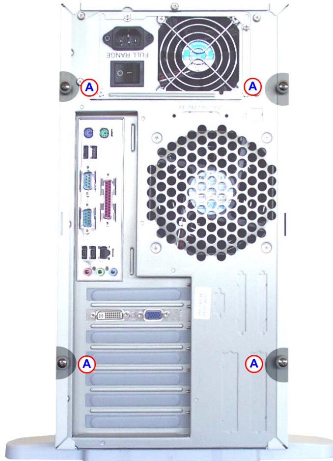
Figura 4. Rimozione della copertura
