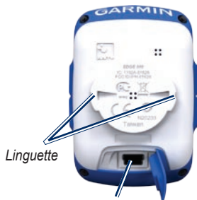
Porta Mini-USB sotto il cappuccio protettivo
