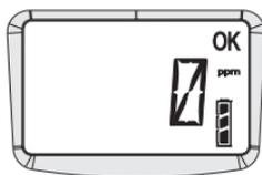
Il canale del sensore mostra il valore corrente del gas monitorato e le unità di misura, e il simbolo "OK" lampeggerà, indicando che l'unità funziona correttamente. Si consiglia di conoscere in dettaglio il gas monitorato dall'unità. Assicurarsi di comprendere a fondo le procedure di prevenzione e sicurezza del luogo. Per ulteriori informazioni sulle letture dei picchi e dei TWA, vedere la sezione 2.4.
