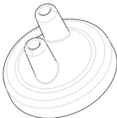
1. Per collocare l'adattatore di flusso nell'unità, farlo slittare sul sensore nella parte frontale dello strumento, fino a bloccarlo saldamente.
