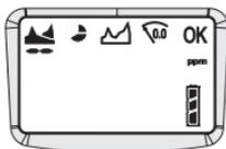
*NB. solamente strumenti per il gas tossici di misurare mostreranno l'opzione di menu di TWA.*
