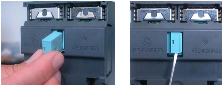
Inserire il C-PLUG (a sinistra) e sfilarlo dal CP (a destra) con l'aiuto di un cacciavite
