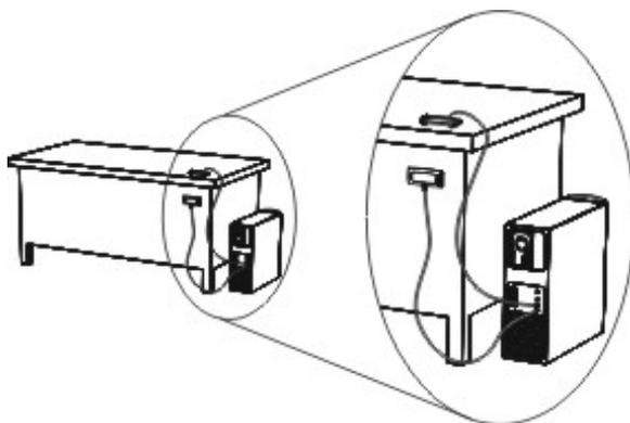
2. Inserire il cavo USB del ricevitore in una porta USB disponibile nel computer.
