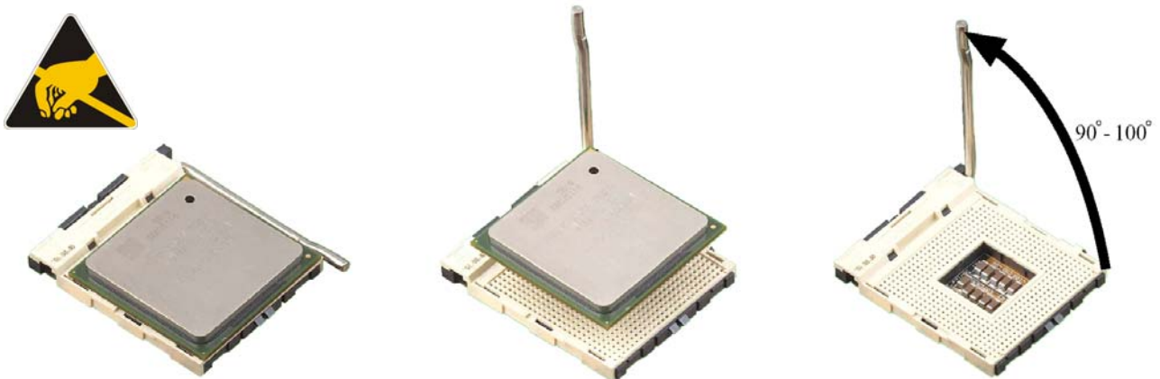
Figura 5. Inserimento/disinserimento della CPU
