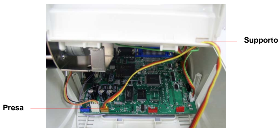
Figura 16. Sistemazione del cablaggio del modulo della taglierina
