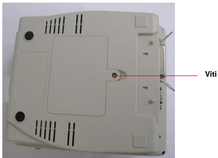
Fig.15 Rimozione di una vite dal fondo
