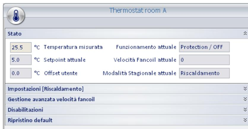
Tramite questo pannello sono visualizzati i valori dei parametri di stato del termostato:
