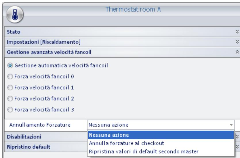
Tramite il pannello “Gestione avanzata velocità fancoil” è possibile modificare manualmente la velocità del fancoil. Sono disponibili i seguenti comandi:
