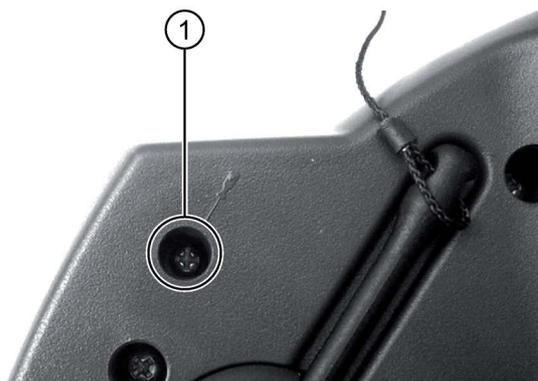
4. Svitare la vite ① sul lato in cui si trova la penna touch da sostituire.
