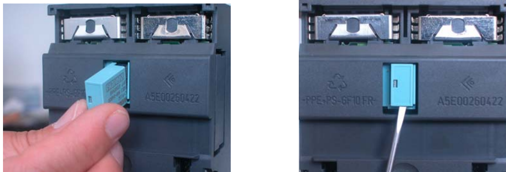
Figura 3-2 Inserimento del C-PLUG e rimozione del C-PLUG dal CP con l'aiuto di un cacciavite
