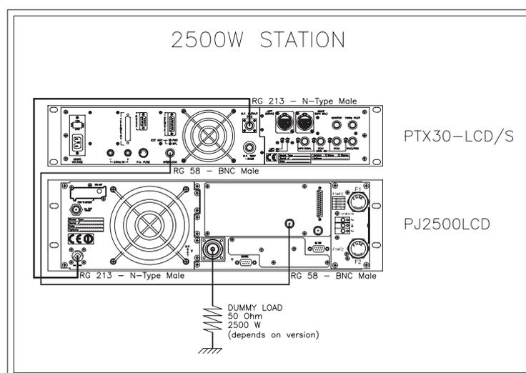
Figura 5.1: collegamento con l'amplificatore
