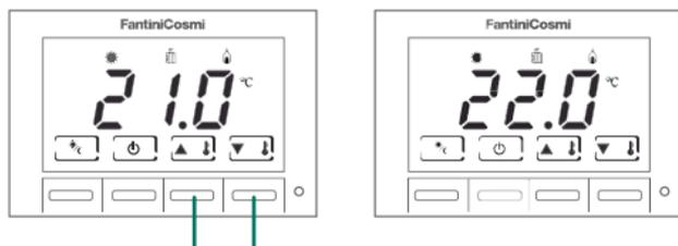
Una volta impostato il modo di funzionamento desiderato ☀ ☾ ⏻ premere uno dei due tasti per impostare (incrementare ▲ o diminuire ▼) la temperatura:
