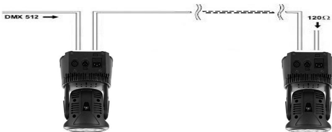
Utilizzare un cavo conforme alle specifiche EIA RS-485: bipolare intrecciato, schermato, 120Ohm di impedenza caratteristica e bassa capacità (PROEL DMXD – DMXD1).
