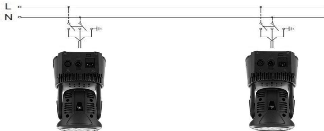
Il dispositivo deve essere collegato ad un sistema di alimentazione dotato di un'efficiente messa a terra. Inoltre, si consiglia di proteggere le linee di alimentazione dei prodotti dai contatti indiretti e/o da cortocircuiti verso massa utilizzando interruttori differenziali opportunamente dimensionati.
