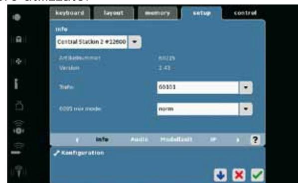
L'impostazione del trasformatore utilizzato tramite "Trafo". Esso deve essere impostato con il trasformatore in possesso, altrimenti in caso di picchi di potenza lo spegnimento può causare la perdita di dati. Se la potenza del trasformatore in possesso è insufficiente, provvedere legando un ripetitore (booster) nel vostro impianto.
