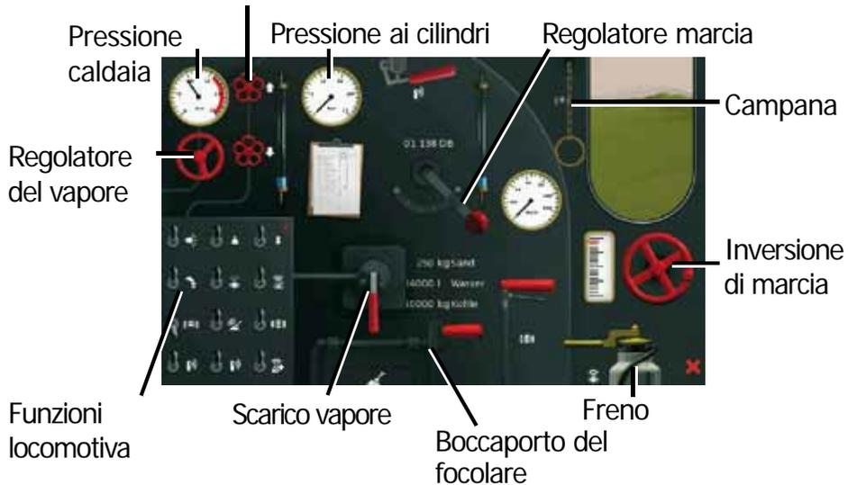
La guida in cabina è "reale", con il risultato che, per esempio, quando l'acceleratore viene chiuso, la locomotiva si ferma solo quando si aziona il freno.
