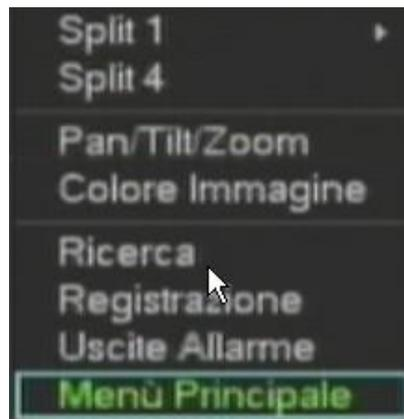
Sono presenti: la scelta del tipo di visualizzazione (split...); l'accesso alle funzioni PTZ; ricerca filmati; l'accesso al menu principale, è possibile anche visionare, arrestare e modificare lo stato delle registrazioni e delle uscite allarme. È presente anche la funzione colore immagine che prevede la gestione di luce, contrasto etc. sulle uscite principali (CVBS, VGA e HDMI) anche su 2 fasce orarie diverse.
