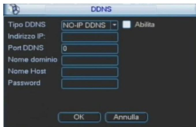
Selezionare il tipo di DDNS : CN99 DDNS, NO-IP DDNS, DDNS privato, dyndns DDNS e DDNS sysdns. Tutti i DDNS possono essere validi allo stesso tempo. Inserire i parametri scelti con il gestore del servizio. Cliccare su OK per salvare.
