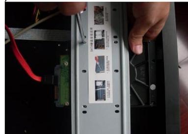
3 Utilizzare Quattro viti per fissare L'HDD..
