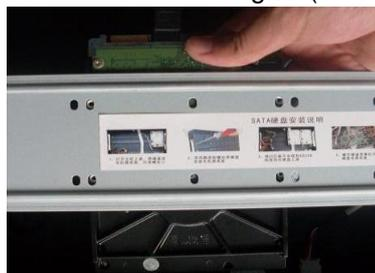
2. Allineare l'HDD con i Quattro fori della staffa dell'HDD.
