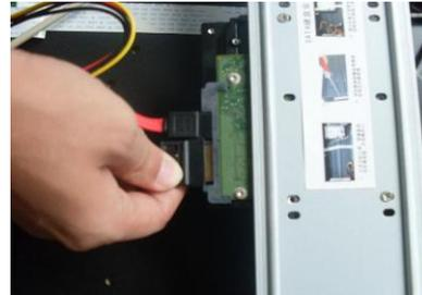
6. Inserire il cavo d'alimentazione dell'HDD
