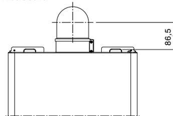
⚠ Qualora fosse necessario installare Junior C.S.I. su impianti già esistenti (sostituzione gamme Ciao N/Mynute), è disponibile il "kit curva coassiale ribassata" che permette di posizionare la caldaia conservando lo stesso foro uscita fumi.
