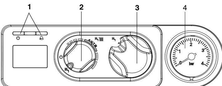
1 Led segnalazione stato caldaia
