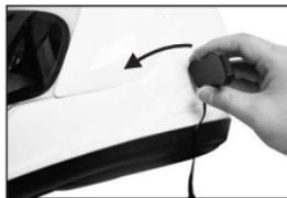
6. Posizionare gli auricolari nel casco insieme ai copri auricolari in velcro, con il centro in corrispondenza delle orecchie, nelle cavità per l'orecchio del casco. Se il casco possiede cavità per l'orecchio troppo profonde è possibile usare i copri auricolari in modo da avvicinare gli auricolari alle orecchie. Attaccare
