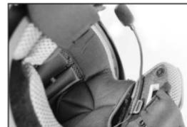
Nel caso del microfono con filo, attaccare l'imbottitura in velcro inclusa per il microfono con filo dentro la protezione per mento nei caschi protettivi per tutta la faccia. Posizionare il microfono con filo sull'imbottitura in velcro e attaccare il connettore del microfono al connettore a 2 pin del cavo dell'unità principale.
