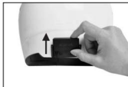
9. È possibile attaccare il set di batterie al lato interno del casco. Attaccare il nastro adesivo dell'auricolare in velcro alla piastra posteriore del set di batterie. Posizionare il set di batterie all'interno del casco, così come mostrato nella figura in basso.
