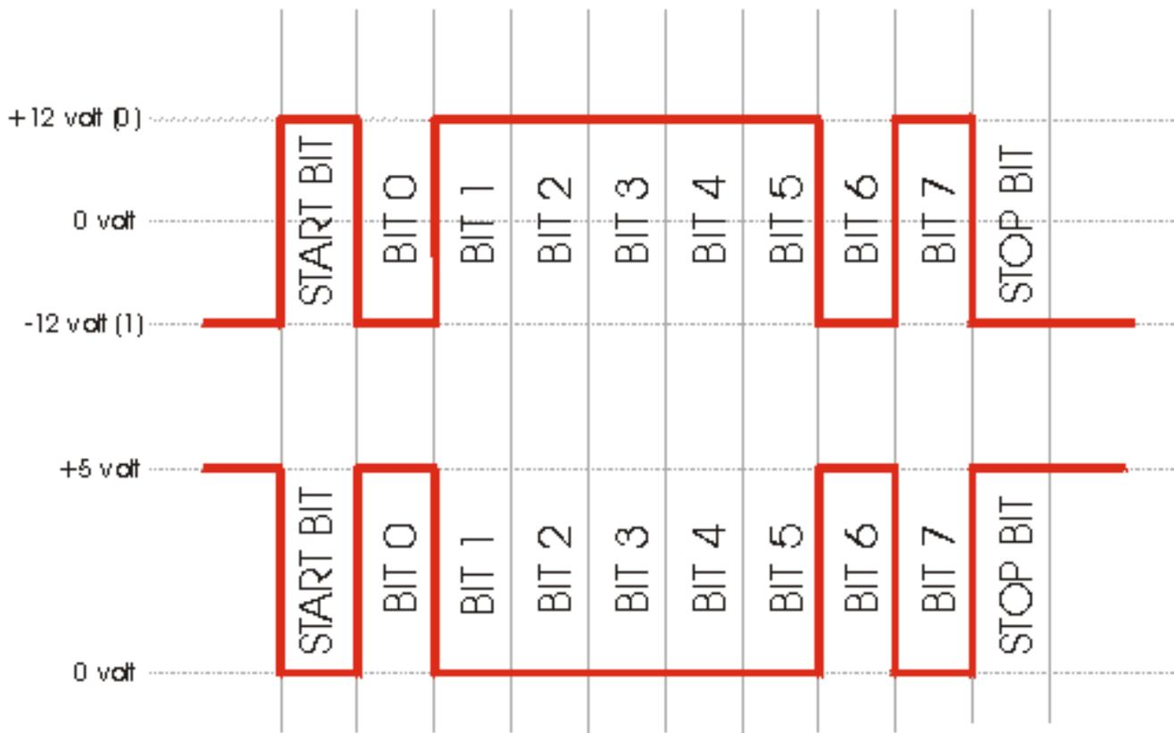
Viceversa sul pin 17 (RA0) il PIC genera i segnali da inviare al PC a livello TTL che vengono convertiti in segnali RS232 da U3 tramite i pin 11 (ingresso TTL) e 14 (uscita RS232) e quindi inviati al PC tramite il pin 2 del connettore J2.
