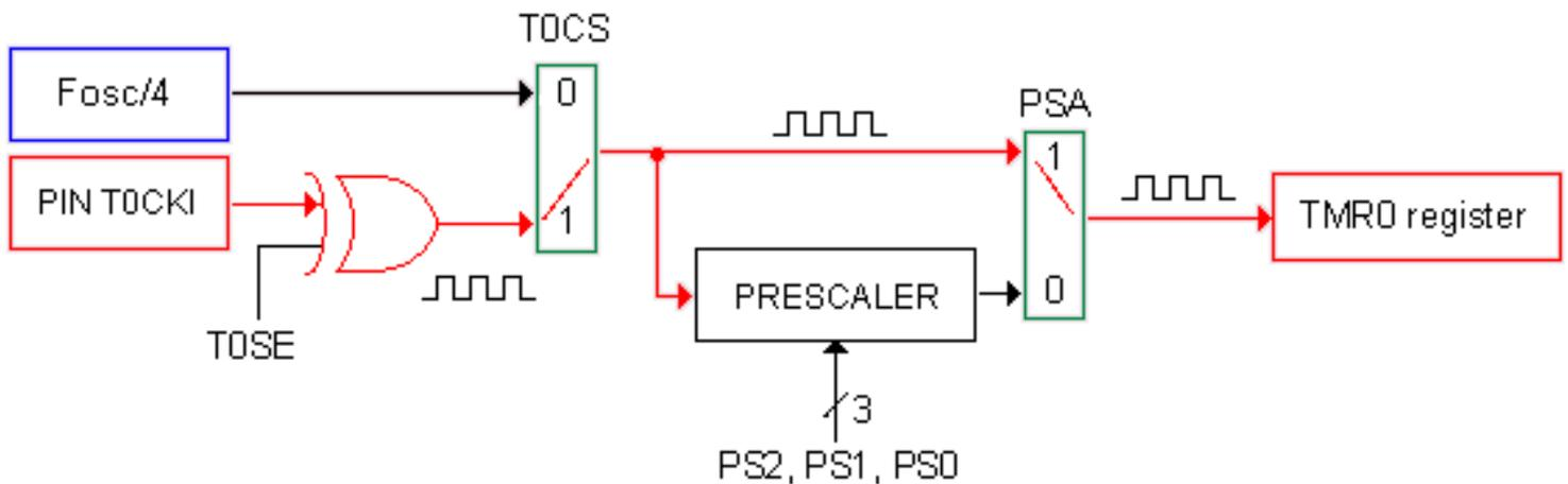
Questa volta sarà il segnale applicato al pin TOCKI del PIC ad essere inviato direttamente al contatore TMR0 determinandone la frequenza di conteggio. Applicando ad esempio a questo pin una frequenza pari ad 100Hz otterremo una frequenza di conteggio pari a cento incrementi al secondo.
