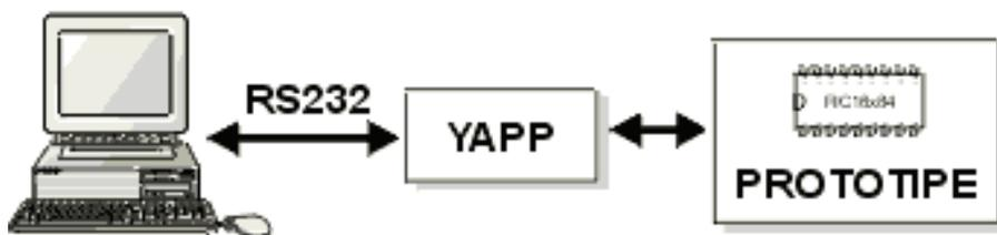
A differenza di molti altri programmatori dello stesso livello, lo Yapp! non utilizza i criteri della porta seriale (DTS e RTS) per generare i segnali di programmazione ma solamente le linee **RXD** e **TXD** per comunicare ad alto livello con il PC. Per permettere questo lo Yapp! contiene a sua volta un PIC programmato che ne gestisce completamente le funzioni.
