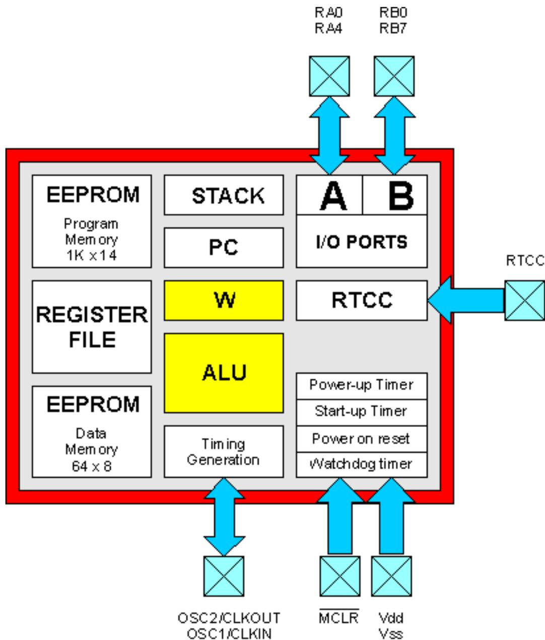
La **ALU** (acronimo di **A**rithmetic and **L**ogic **U**nit ovvero unità aritmetica e logica) è la componente più complessa del PIC in quanto contiene tutta la circuiteria delegata a svolgere le funzioni di calcolo e manipolazione dei dati durante l'esecuzione di un programma.
