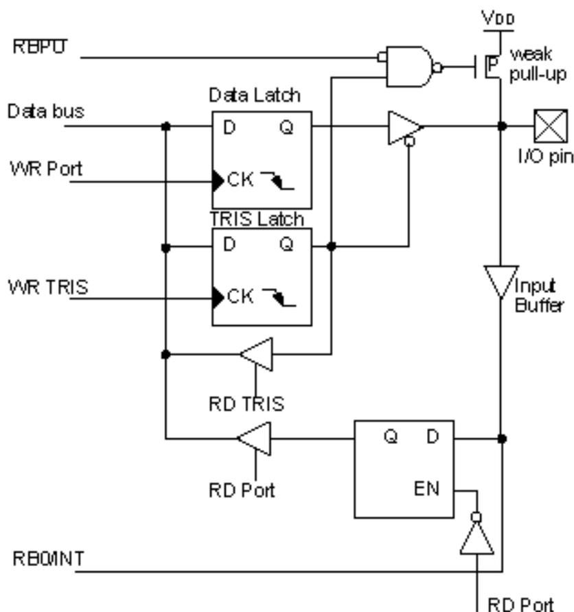
La sola linea **RB0** inoltre, presenta una caratteristica molto particolare. Essa, quando viene configurata come linea di ingresso, può generare, in corrispondenza di un cambio di stato logico, un **interrupt**, ovvero una interruzione immediata del programma in esecuzione ed una chiamata ad una subroutine speciale denominata **interrupt handler**. Ma di questo parleremo in seguito.
