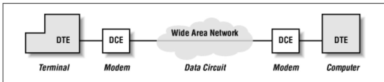
Per usare la RS232 per collegare tra loro due computer vicini senza interporre tra loro alcun modem dobbiamo simulare in qualche modo le connessioni intermedie realizzando un cavo **NULL MODEM** o cavo invertente, ovvero un cavo in grado di far scambiare direttamente tra loro i segnali dai due DTE come se tra loro ci fossero effettivamente i DCE.
