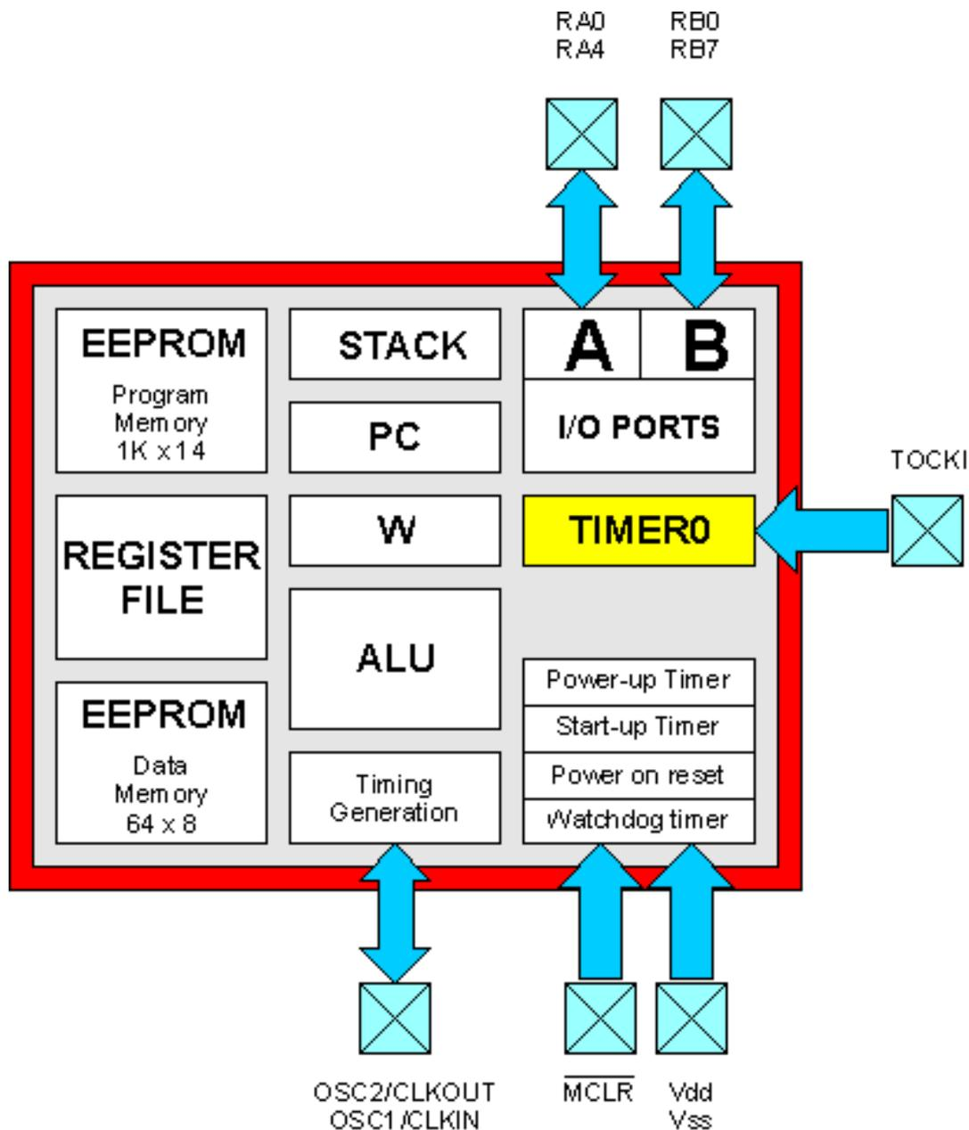
Il registro TMR0 è un contatore, ovvero un particolare tipo di registro il cui contenuto viene incrementato con cadenza regolare e programmabile direttamente dall'hardware del PIC. In pratica, a differenza di altri registri, il TMR0 non mantiene inalterato il valore che gli viene memorizzato, ma lo incrementa continuamente, se ad esempio scriviamo in esso il valore 10 con le seguenti istruzioni:
