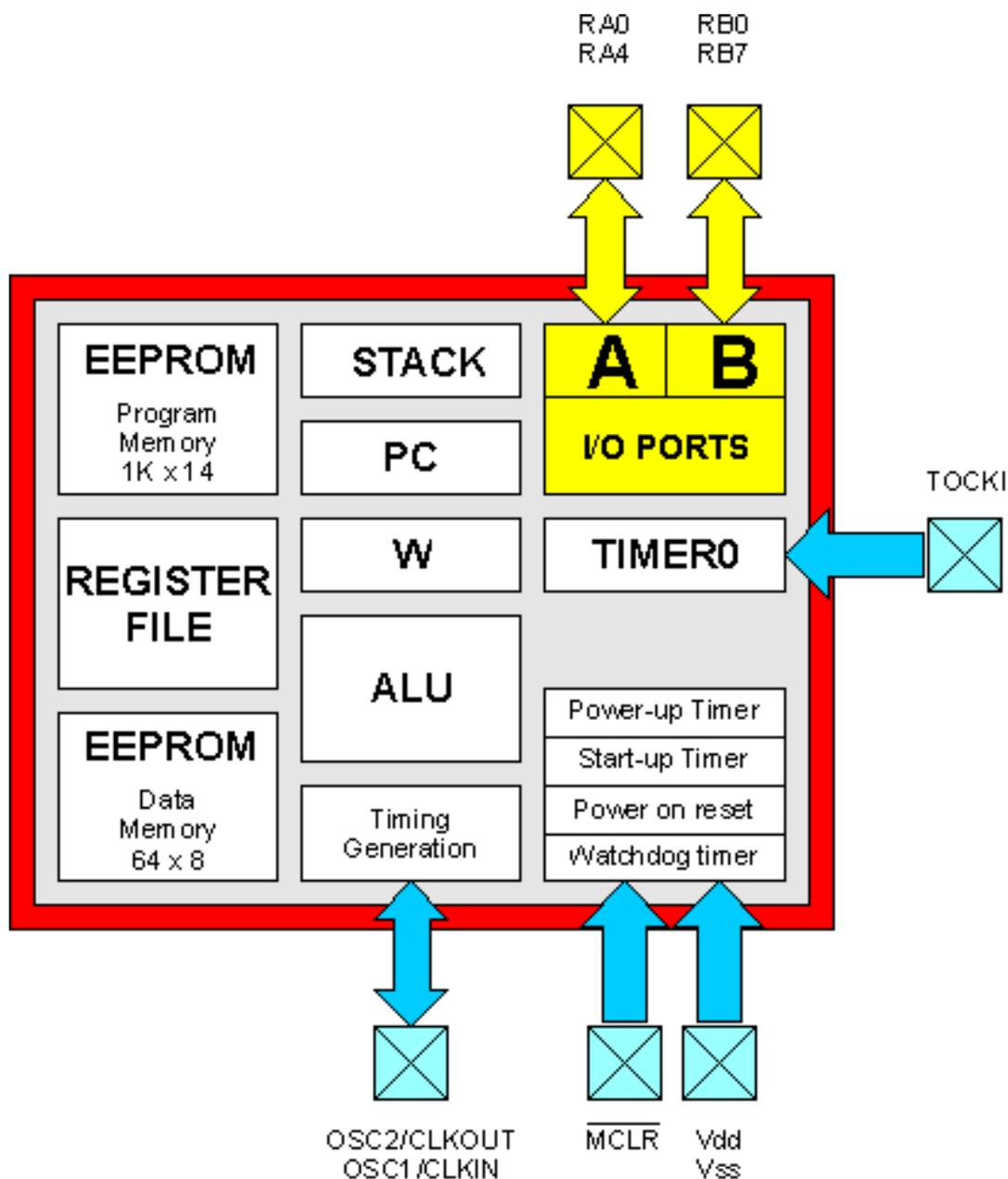
La suddivisione delle linee in due porte distinte è dettata dai vincoli dell'architettura interna del **PIC16F84** che prevede la gestione di dati di lunghezza massima pari a 8 bit.
