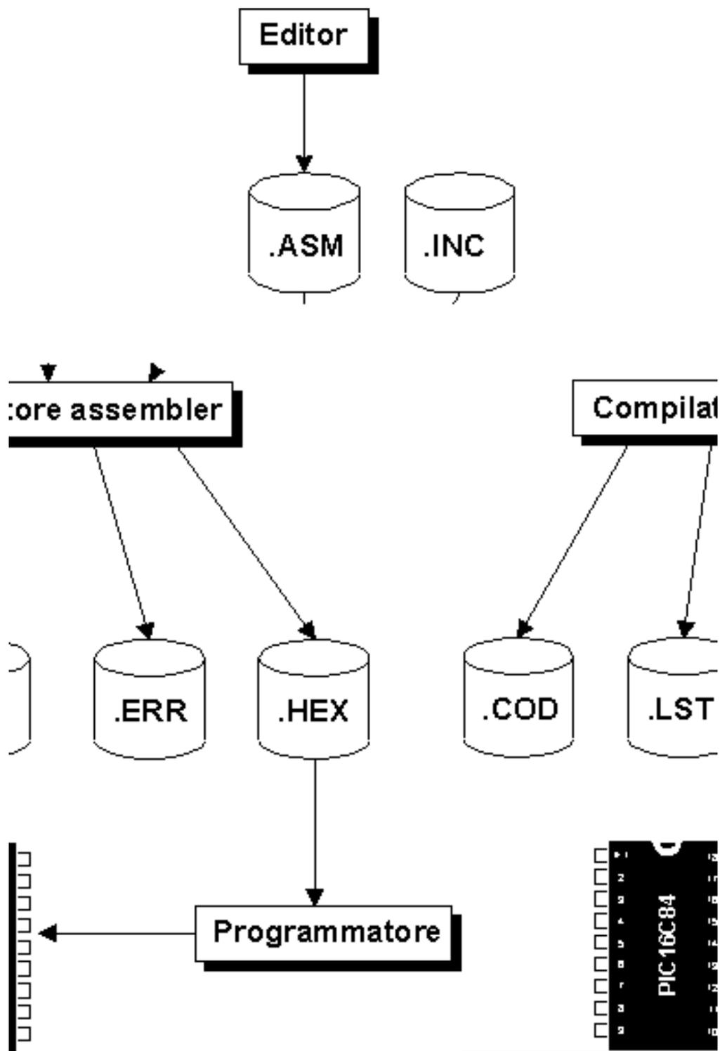
Come già detto, la prima operazione da effettuare è la scrittura del source assembler e la sua memorizzazione in un file di testo. L'estensione di questo file deve essere **.ASM**.
