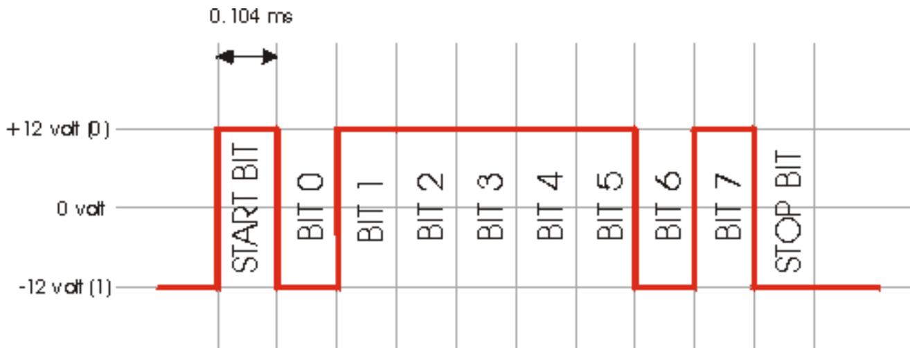
Una volta trasmesso l'ottavo bit (bit 7), il PC aggiunge automaticamente un ultimo bit a 1 denominato **STOP BIT** ad indicare l'avvenuta trasmissione dell'intero byte. La stessa sequenza viene ripetuta per ogni byte trasmesso sulla linea.
