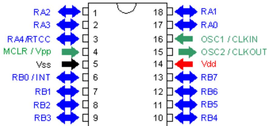
Come è possibile vedere il PIC16F84 è dotato di un totale di **18 pin** disposti su due file parallele da 9 pin ciascuna. I pin contrassegnati in **BLU** rappresentano le linee di I/O disponibili per le nostre applicazioni, i pin in **ROSSO** e **NERO** sono i pin di alimentazione, i pin in **VERDE** sono riservati al funzionamento del PIC (MCLR per il reset e OSC1-2 per il clock).
