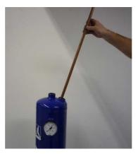
4. Ricaricare il carbone attivo nel contenitore fino al bordo inferiore del distributore di aria compressa. Utilizzare solo carbone attivo originale di BEKO TECHNOLOGIES GMBH. Utilizzare per il riempimento un imbuto disponibile in commercio.
