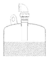
Montare il tappo di chiusura con la guarnizione sul bocchettone di riempimento del contenitore. Nel CLEARPOINT<sup>®</sup> L 205 VWM montare il distributore di aria compressa e ricreare poi il collegamento al sistema di tubature.
