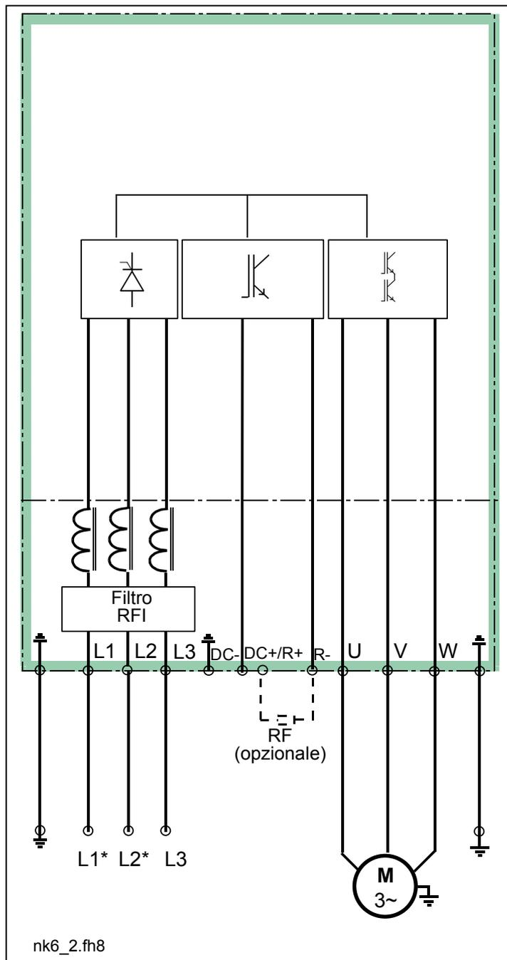
Figura 6-2. Schema elettrico principale dell'unità di potenza FR6 (500V), FR7 and FR8
