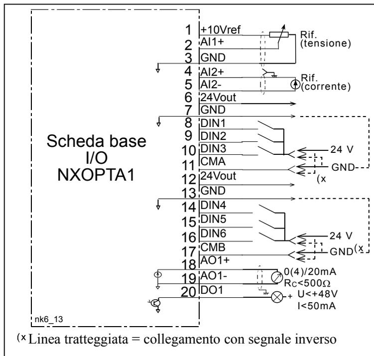
Figura 6-22. Schema elettrico generale della scheda base I/O (NOPT-A1)
