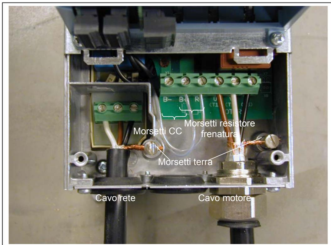
Figura 6-6. Installazione dei cavi nel Vacon NX, FR4
