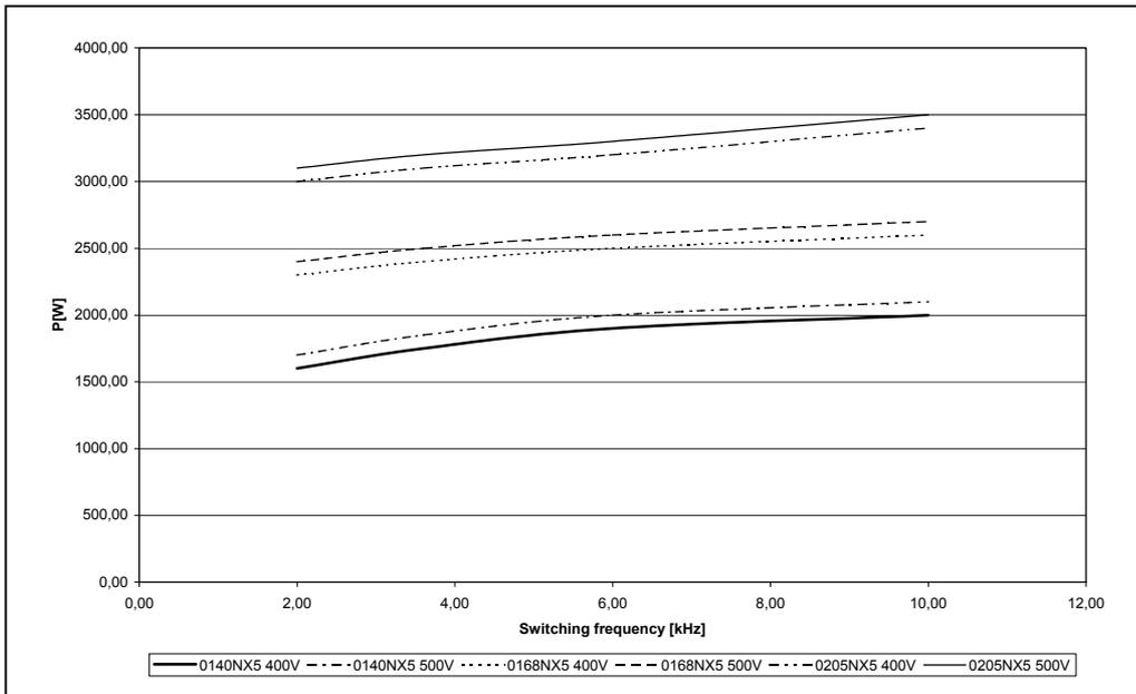
Figura 5-16. Potenza dissipata in funzione della frequenza di commutazione; 0140...0205NX5
