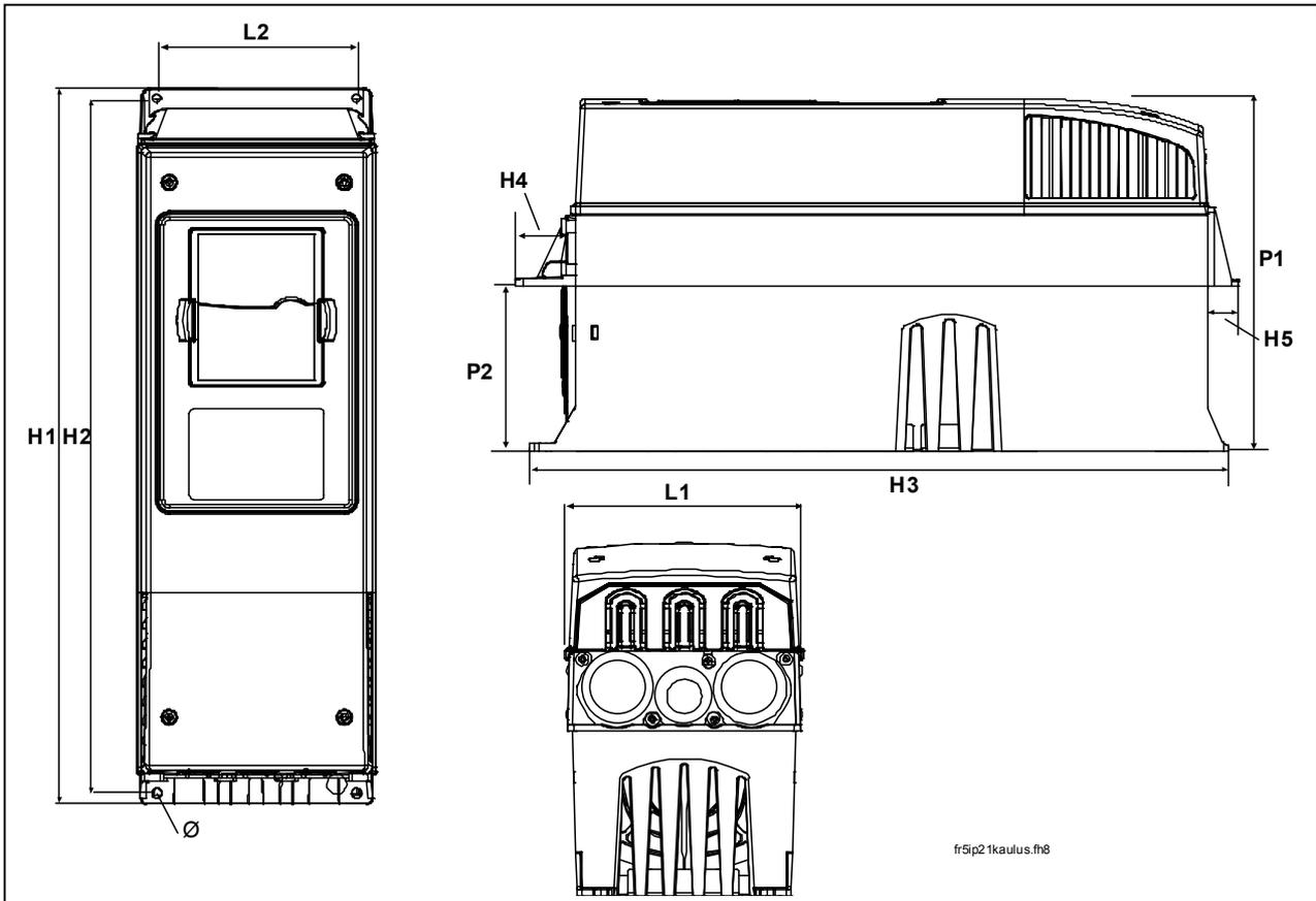
Figura 5-2. Dimensioni di ingombro del Vacon NX, montaggio a flangia con grado di protezione IP21, da FR4 a FR6
