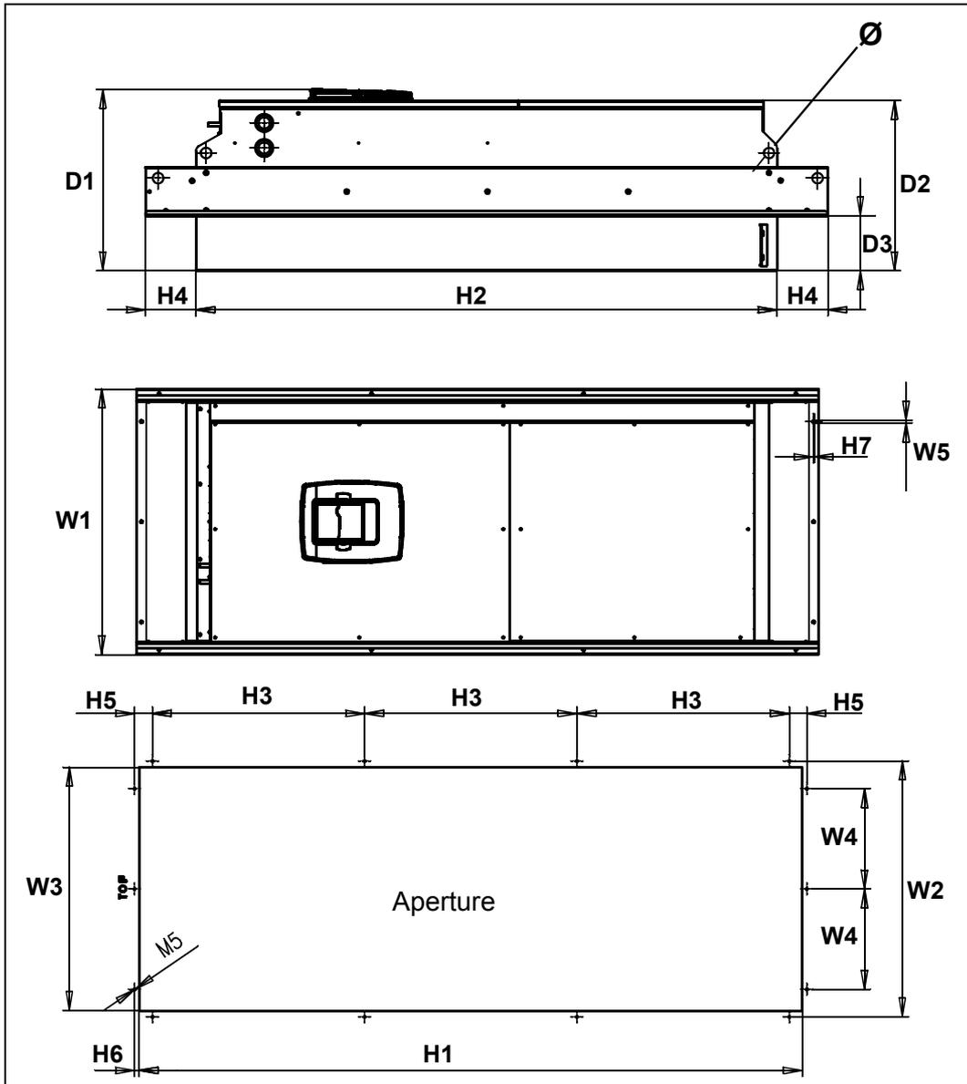
Figura 5-7. Dimensioni di ingombro dei Vacon NX. L'installazione a flangia FR9
