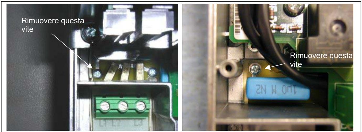
Figura 5-18. Cambio della classe di protezione EMC, FR4 (a sinistra) e FR5 (a destra).
