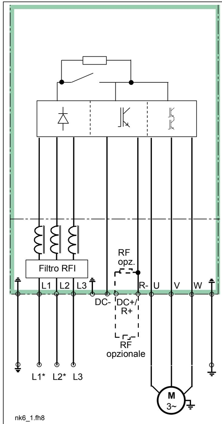
Figura 6-1. Schema elettrico principale dell'unità di potenza FR4 a FR5 e FR6 (690V)
