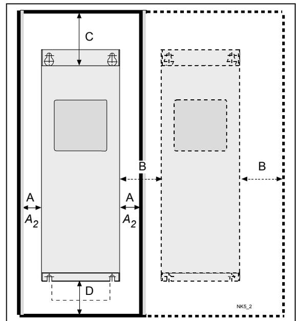
Figura 5-10. Spazio di installazione
