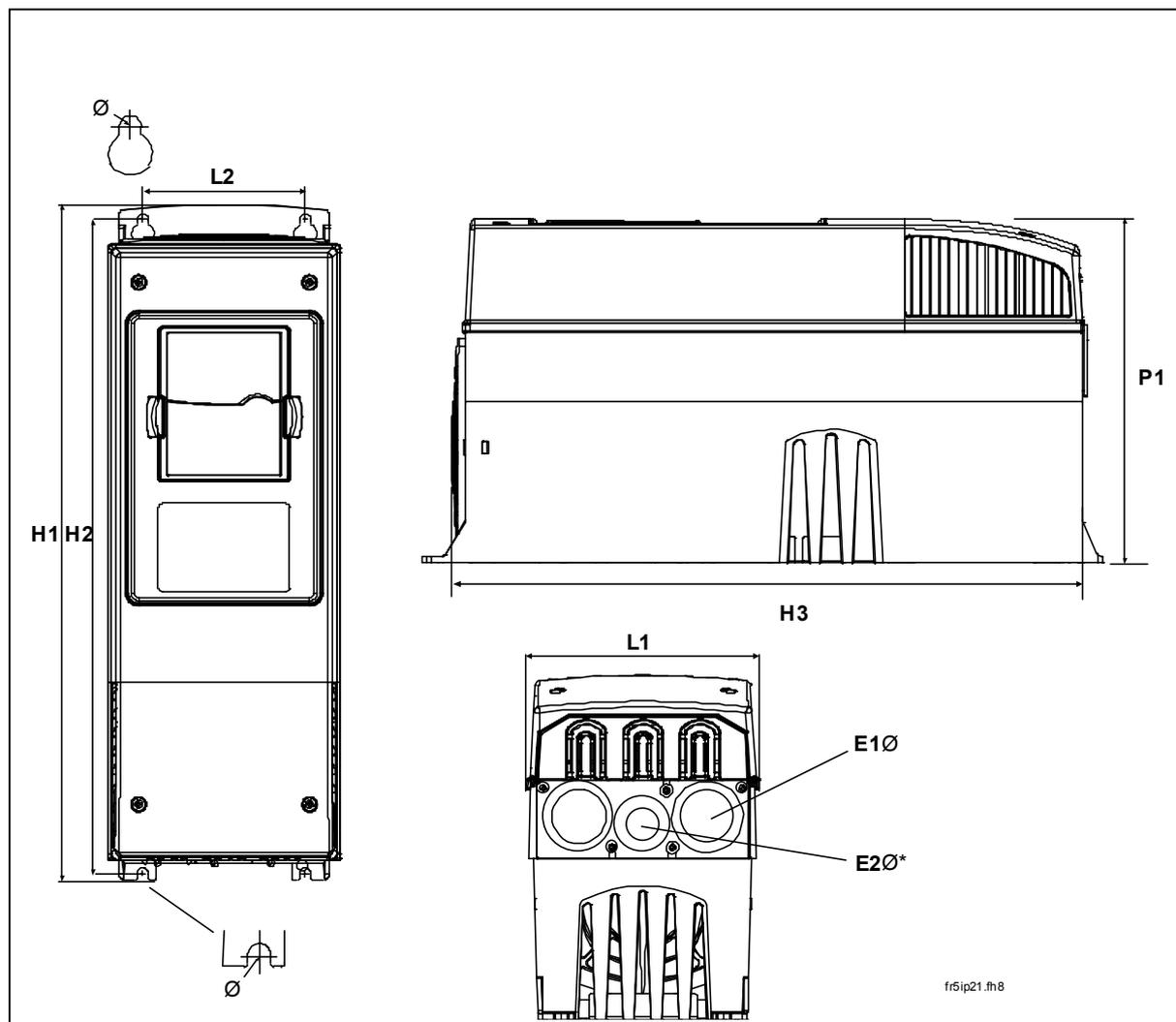
Figura 5-1. Dimensioni di ingombro dei Vacon NX con grado di protezione IP21
