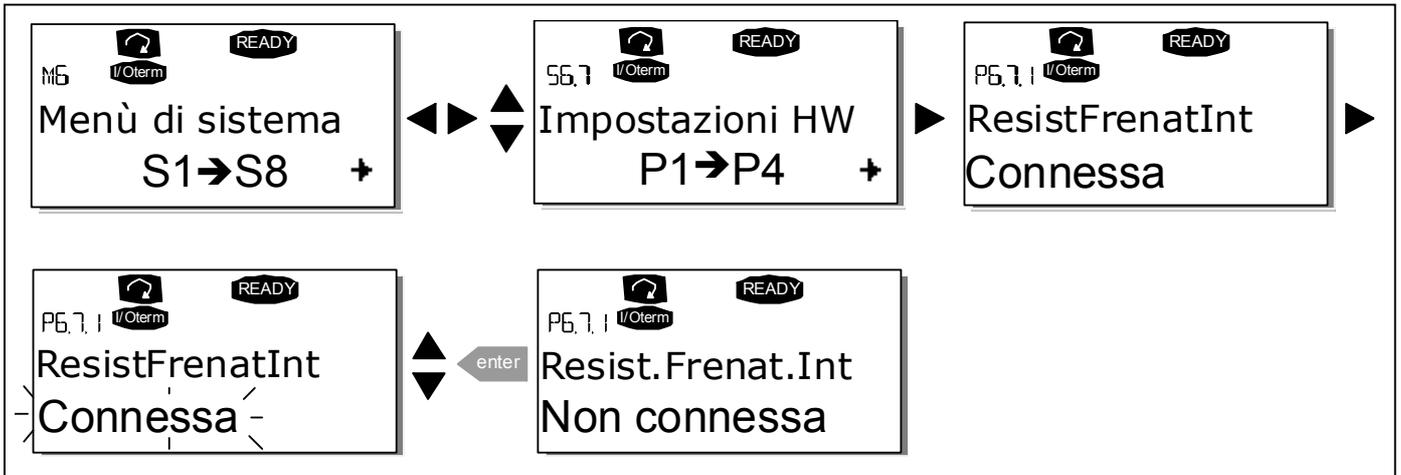
Figura 7-21. Collegamento resistore di frenatura interno
