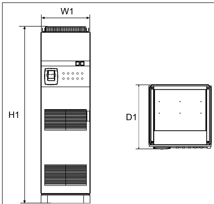
Figura 5-8. Armadio per l'installazione del FR10
