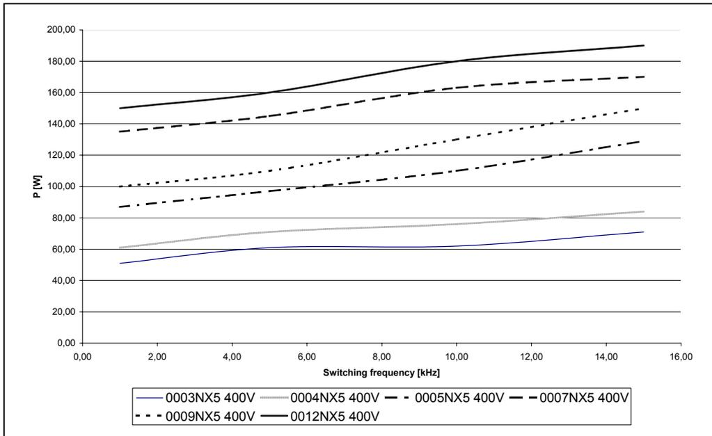
Figura 5-12. Potenza dissipata in funzione della frequenza di commutazione; 0003...0012NX5
