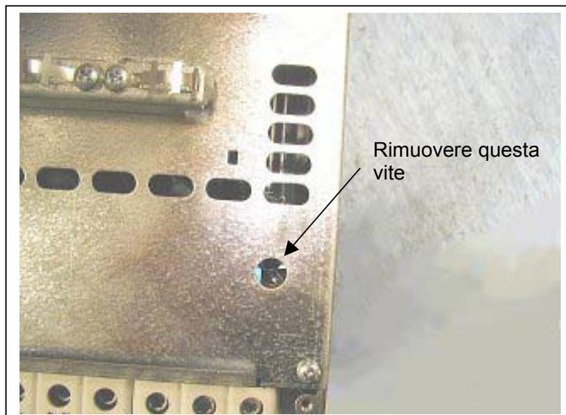
Figura 5-19. Cambio della classe di protezione EMC, FR6
