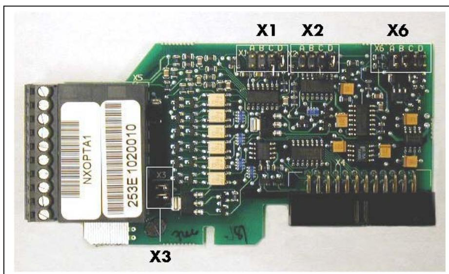
Figura 6-26. Blocchi di ponticelli sulla scheda NOPT-A1
