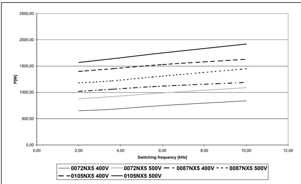
Figura 5-15. Potenza dissipata in funzione della frequenza di commutazione; 0072...0105NX5
