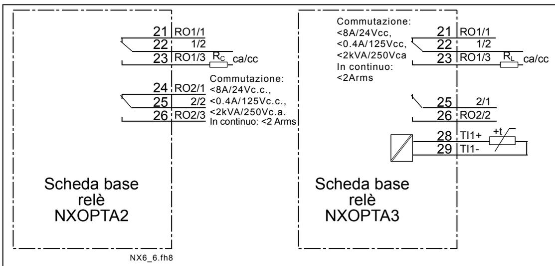
Figura 6-23. Schema elettrico generale della scheda base relè (NOPT-A2 e NOPT-A3)
