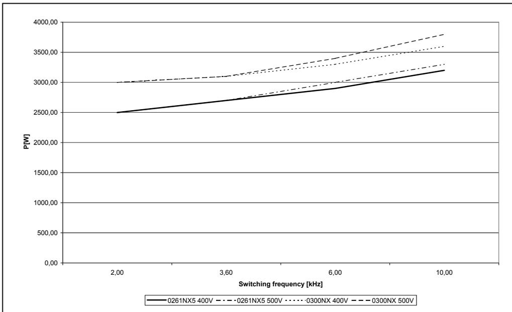
Figura 5-17. Potenza dissipata in funzione della frequenza di commutazione; 0261...0300NX5
