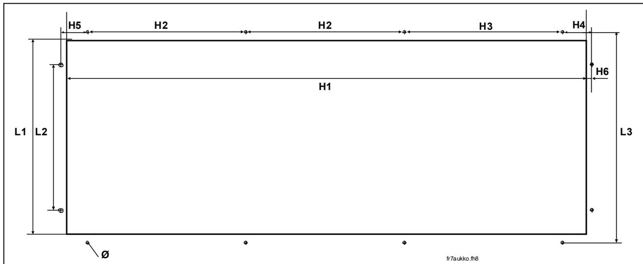
Figura 5-5. Aperture necessarie per l'installazione a flangia, FR7/FR8
