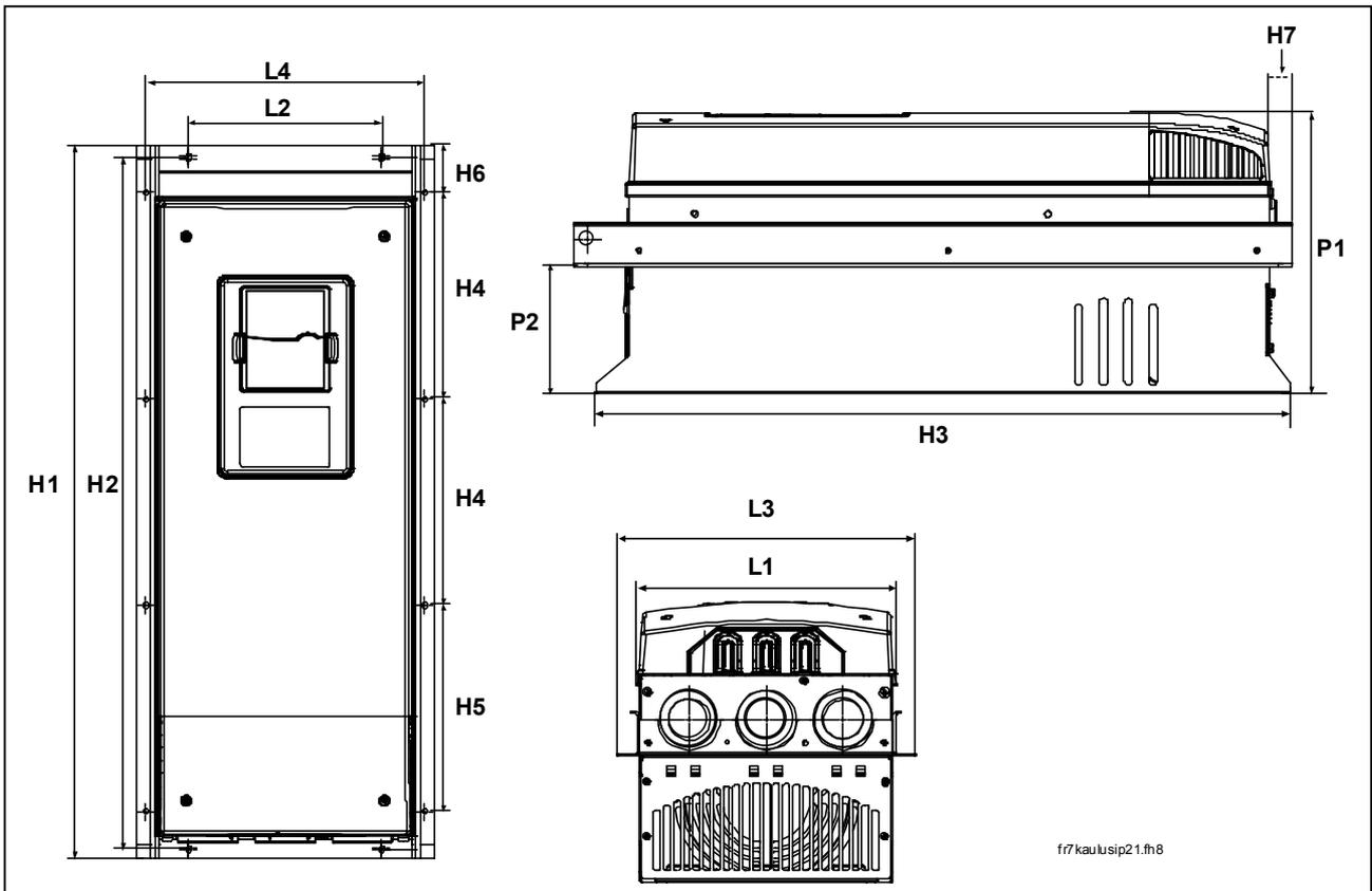
Figura 5-4. Dimensioni ingombro Vacon NX, dalla taglia FR7 alla FR8, montaggio a flangia con grado di protezione IP21
