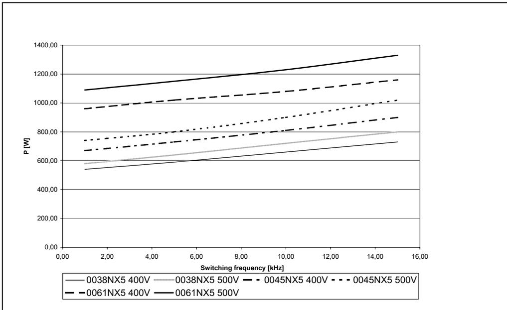
Figura 5-14. Potenza dissipata in funzione della frequenza di commutazione; 0038...0061NX5
