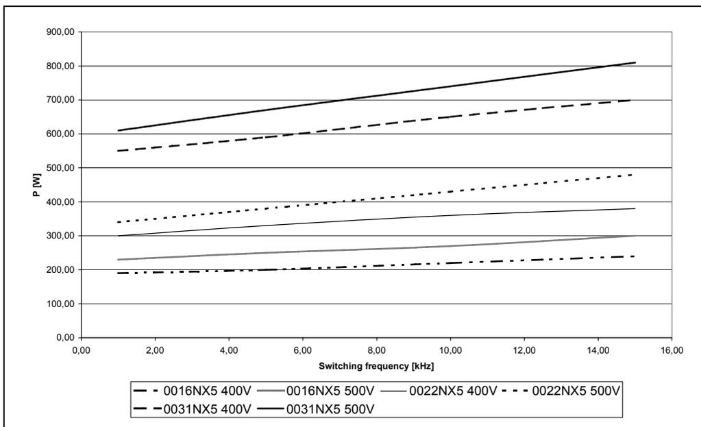
Figura 5-13. Potenza dissipata in funzione della frequenza di commutazione; 0016...0031NX5
