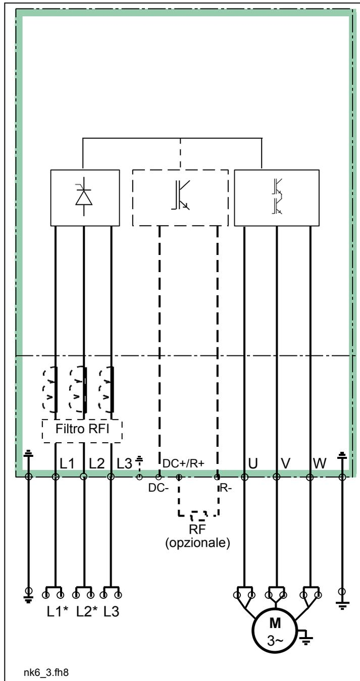
Figura 6-3. Schema elettrico principale dell'unità di potenza, FR9 a FR10. Le linee tratteggiate si riferiscono a componenti presenti internamente nella taglia FR9 ma non nella taglia FR10
