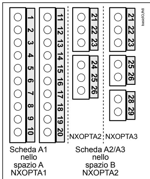
Figura 6-21. Morsetti I/O delle due schede base
