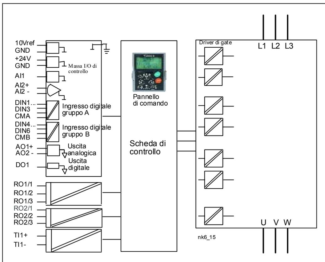
Figura 6-24. Barriere di isolamento galvanico.
