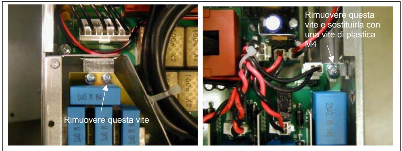
Figura 5-20. Cambio della classe di protezione EMC, FR7
