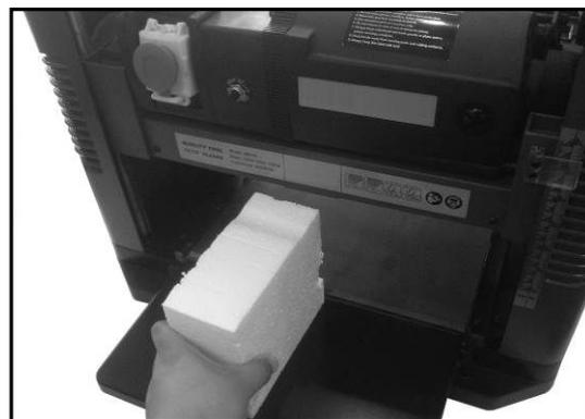
Figura 9 – Rimozione polistirene.
