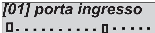
Nella figura sopra, sono stati messi in test gli ingressi 1 e 12 (quelli con il quadrato).
