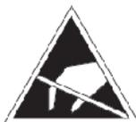
**Durante l'installazione o l'uso di questo strumento è obbligatorio attuare misure di protezione dalle scariche elettrostatiche.**
