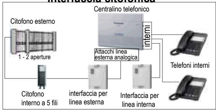
Connette il citofono tradizionale (a 5 FILI) al centralino telefonico. In 2 versioni: collegamento su attacco di linea esterna o su linea interna. Può comandare fino a 2 contatti (elettroserrature, carichi elettrici etc.)
