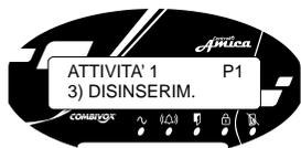
**3) disinserim.:** programmando questa funzione, l'Amica 64 Plus si disinserisce all'orario del giorno programmato. Digitare e selezionare (da 1 a 8) le aree che si devono disinserire automaticamente. Per selezionare rapidamente tutte le aree programmate digitare il tasto . Per programmare premere ;
