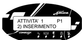
**2) inserimento:** programmando questa funzione, l'Amica 64 Plus si inserisce all'orario del giorno programmato. Digitare e selezionare (da 1 a 8) le aree che si devono inserire automaticamente. Per selezionare rapidamente tutte le aree programmate digitare il tasto . Per programmare premere ;
