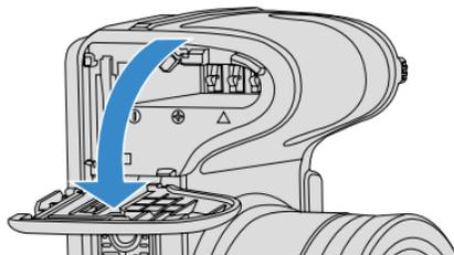
2. Inserire la batteria osservando la polarità corretta. Usare il lato della batteria per premere l'otturatore come mostrato, permettendo alla batteria di bloccarsi correttamente in posizione.
