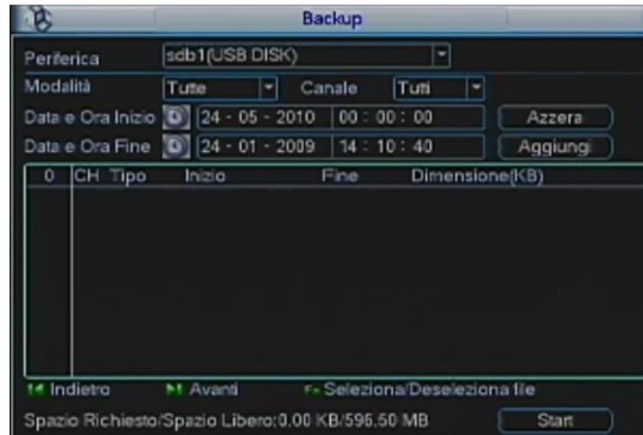
Il formato del nome del file è di solito: SN\_CH + numero del canale + modo di registrazione + tempo Y + M + D + H + M + S. Nel nome del file, il formato YDM è lo stesso che si imposta sull'interfaccia in generale. (Menu principale -> Configurazione -> Generale). L'estensione del file è .Dav.
