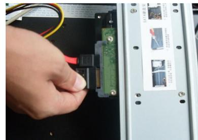
6. Inserire il cavo d'alimentazione dell'HDD
