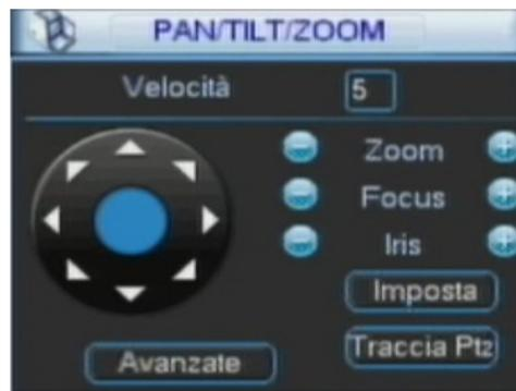
Cliccare sulle frecce di direzione per regolare la posizione PTZ. Ci sono complessivamente 8 frecce di direzione.
