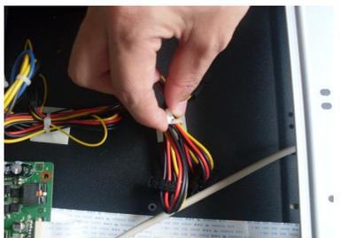
4. Staccare il cavo di alimentazione dell'HDD dopo aver completato l'installazione dell'HDD
