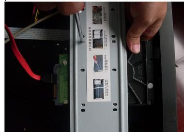
3 Utilizzare Quattro viti per fissare L'HDD..
