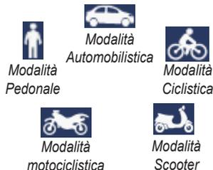
zūmo offre diverse modalità d'uso per differenti modalità di trasporto. Il percorso e la navigazione vengono calcolati in maniera diversa a seconda del modo d'uso. Ad esempio, le strade a senso unico vengono considerate diversamente per il modo pedonale o per il modo automobilistico.
