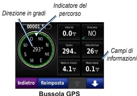
È possibile navigare mediante una bussola GPS. Non è richiesta la calibrazione; tuttavia, è necessaria una vista del cielo libera. Toccare un campo dati nella pagina Mappa per visualizzare la bussola. Durante il viaggio, la bussola ruota. L'indicatore del percorso mostra la direzione del viaggio. La direzione viene anche visualizzata in gradi al centro della bussola. I campi delle
