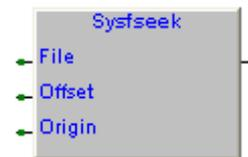
La funzione ritorna il valore attuale dell'indicatore di posizione. In caso di errore di posizionamento, l'indicatore di posizione rimane inalterato e la funzione ritorna **EOF**.
