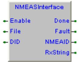
L'FB riceve le sentenze NMEA dal dispositivo, ne controlla il prefisso comparandolo con la stringa definita in **DID**, controlla se la sentenza ricevuta è corretta (Controllo sul CRC). L'uscita **Done** si attiva per un loop ad ogni ricezione di sentenza NMEA corretta.
