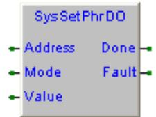
**Address** (USINT) Occorre specificare l'indirizzo del modulo su cui eseguire l'impostazione delle uscite digitali (Range da 0 a 255). Il valore 0 indica il primo modulo di estensione, 1 il secondo e così di seguito. L'indirizzo 255 indica il modulo CPU.
