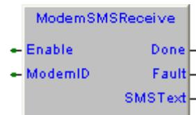
Alla ricezione di un messaggio SMS si attiva per un loop di programma l'uscita **Done**, sull'uscita **SMSText** viene ritornato il messaggio ricevuto, all'uscita **CLIPNumber** della FB **ModemCore** è ritornato il numero di telefono da cui il messaggio è stato ricevuto. Il testo del messaggio ricevuto rimane presente in uscita sino alla ricezione di un altro messaggio.
