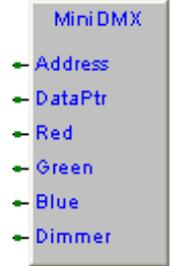
Il blocco funzione viene chiamato **MiniDMX**, sulla destra è possibile vedere come verrà visualizzato il blocco funzione nel proprio programma LD. Il programma in codice sorgente del blocco funzione e del programma di esempio si trova nel **Ptp117\*000**.
