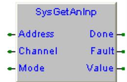
**Address** (USINT) Occorre specificare l'indirizzo del modulo da cui eseguire l'acquisizione analogica (Range da 0x00 a 0x0F). Il valore 0x00 indica il primo modulo di estensione, 0x01 il secondo e così di seguito.
