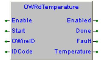
Attivando il comando di **Start**, viene eseguita la lettura del valore di temperatura dal dispositivo connesso al bus One-Wire. Se la lettura ha esito positivo si attiva per un loop di programma l'uscita **Done** e su **Temperature**, sarà riportato il valore di temperatura acquisito. L'uscita **Fault** si attiva per un loop di programma in caso di errori di gestione.
