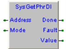
**Address** (USINT) Occorre specificare l'indirizzo di modulo da cui eseguire l'acquisizione degli ingressi digitali (Range da 0 a 255). Il valore 0 indica il primo modulo di estensione, 1 il secondo e così di seguito. L'indirizzo 255 indica il modulo CPU.
