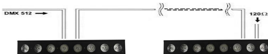
Utilizzare un cavo conforme alle specifiche EIA RS-485: bipolare intrecciato, schermato, 120Ohm di impedenza caratteristica e bassa capacità (PROEL DMXD – DMXD1).
