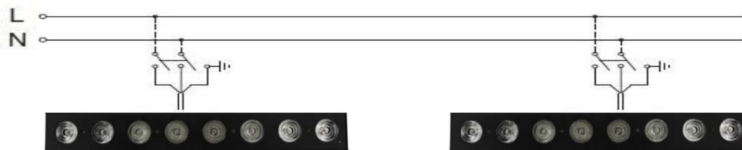
Il dispositivo deve essere collegato ad un sistema di alimentazione dotato di un'efficiente messa a terra. Inoltre, si consiglia di proteggere le linee di alimentazione dei prodotti dai contatti indiretti e/o da cortocircuiti verso massa utilizzando interruttori differenziali opportunamente dimensionati.
