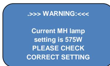
Il sistema vi avverte che Infinity M è impostato per funzionare con una lampada da 575W.
